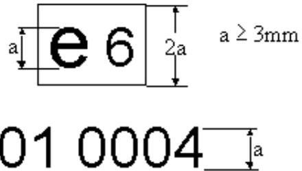
Légende: la réception du type de composant ci-dessus a été octroyée par la Belgique sous le numéro 0004.01 est le numéro séquentiel désignant le niveau des exigences techniques auxquelles ce composant est conforme. Le numéro séquentiel est attribué conformément aux directives particulières ou aux règlements particuliers correspondants.
