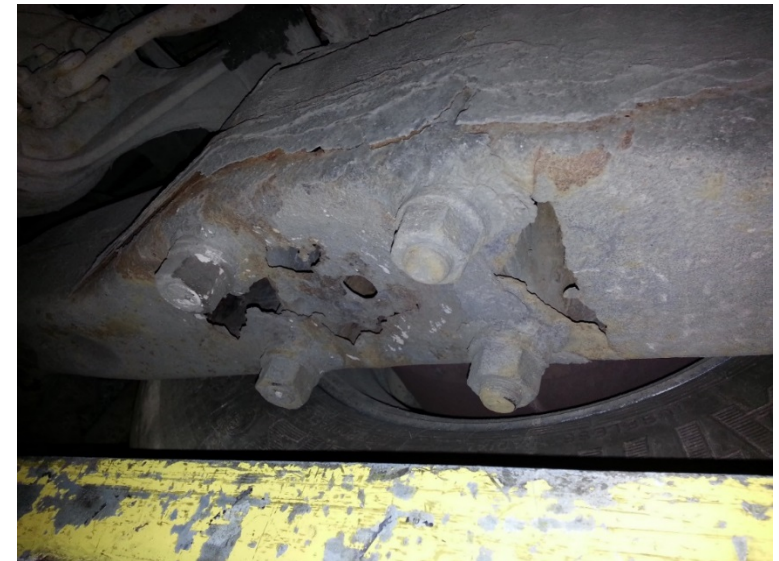
Achskörper (Reisebus) großflächig durchrostet
