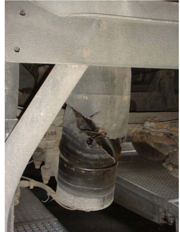
Luftfederbalg (Sattelanhänger) geplatzt
