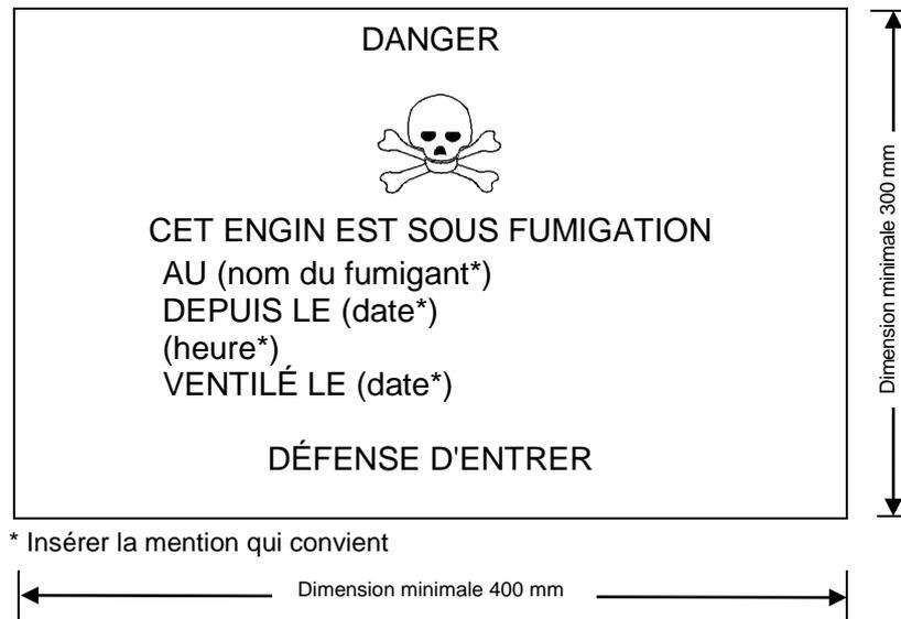
**Figure 9.1 - Marque de mise en garde pour les engins sous fumigation**
