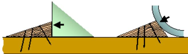
**Figure 7.7 - Cales de blocage correctement taillées et clouées**
