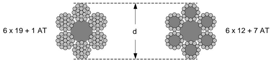
**Figure 7.13 - Commettage type d'un câble de saisissage métallique**
