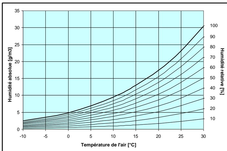
Figure 3.1 - Humidité absolue et humidité relative
