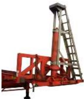
**Figure 8.9 - Échelle d'accès fixée à la remorque**
