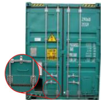
**Figure 8.4 - Barreaux d'un conteneur pour vrac**
