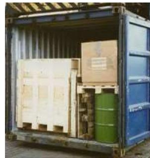
**Figure 7.28 - Arrimage mixte avec utilisation de palettes**
