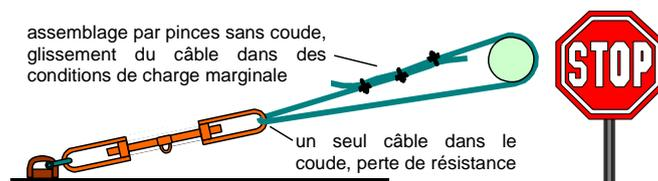
**Figure 7.15 6 - Mauvais assemblage de saisine en câble métallique**
