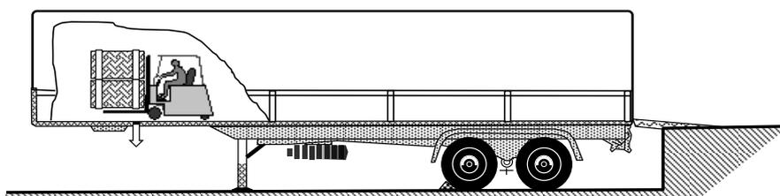
**Figure 5.2 - Maintien de la remorque inapproprié**
