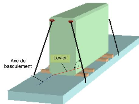
**Figure 7.39 - Saisissage direct visant à empêcher le basculement**
