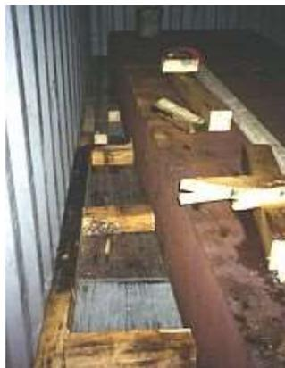
**Figure 7.45 - Immobilisation transversale de plaques d'acier**
