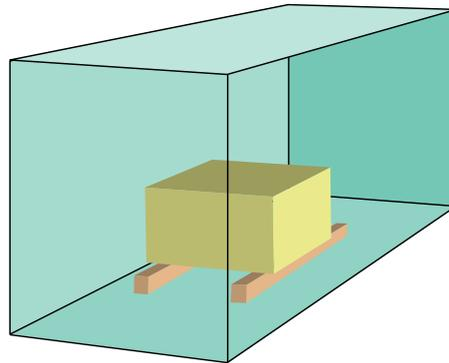
**Figure 7.21 - Poutres de transfert de charge**
