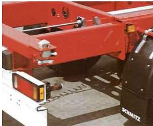
**Figure 2.1 - Verrou tournant à bord d'un véhicule routier**
