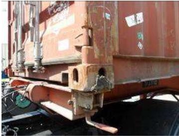
**Figure 6.2 - Boue dans une pièce de coin**
