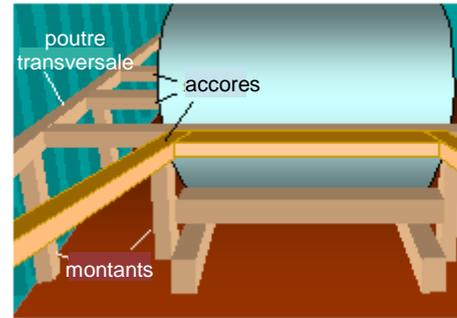
**Figure 7.5 - Dispositif d'accorage avec montants et poutre transversale**
