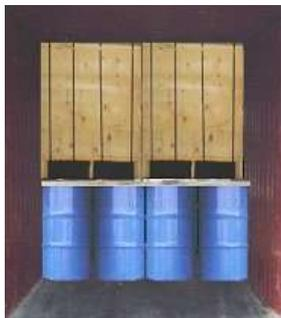
**Figure 7.27 - Arrimage mixte avec des marchandises sèches au-dessus de marchandises humides**
