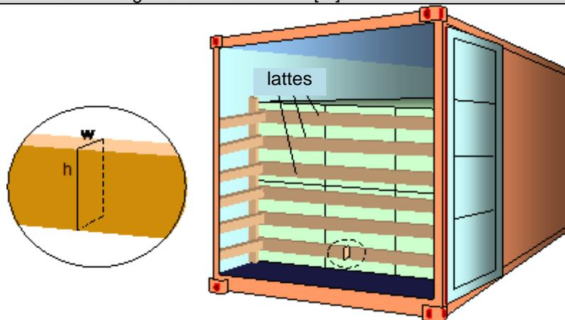
Figure 7.57 – Lattes transversales disposées dans un conteneur
