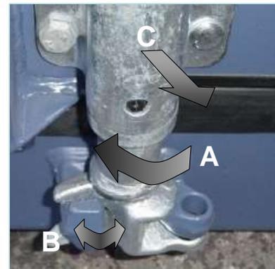
**Figure 5.28 - Fonctionnement d'une came de porte**
