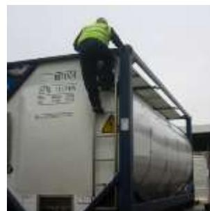
**Figure 8.7 - Passer du passavant à l'échelle**
