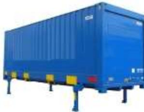
**Figure 5.6 - Caisse mobile débarquée et positionnée sur béquilles**
