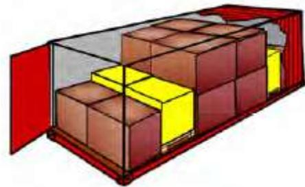
Figure 7.34 - Seuil par élévation
